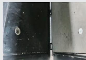
脱型時にヘッドが折れ、残りがねじ式保護キャップに。
