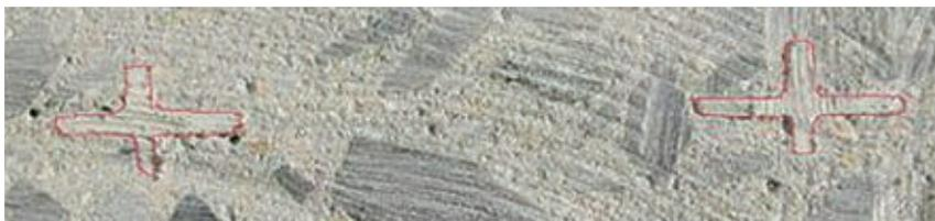
コンクリートを打設した星形スペーサー(プラスターG)の切断面
