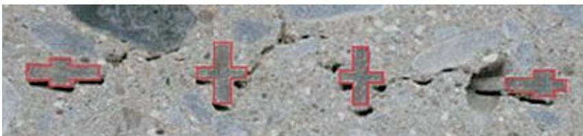
コンクリートを打設したドーナツ型スペーサーの切断面
