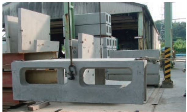
TLインサートでの反転例
